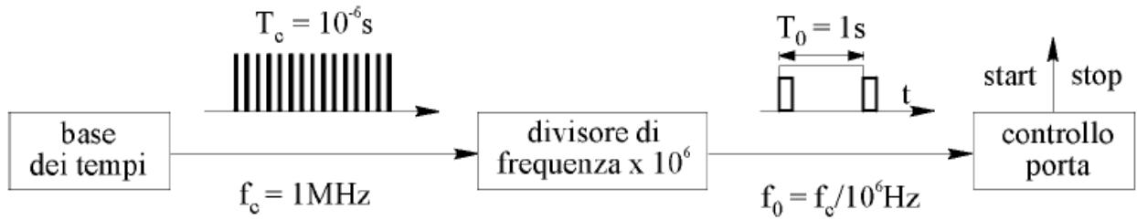
Schema per il divisore di frequenza.
