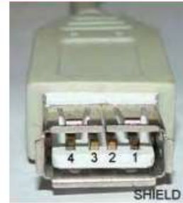
■ Pinout del connettore USB:
